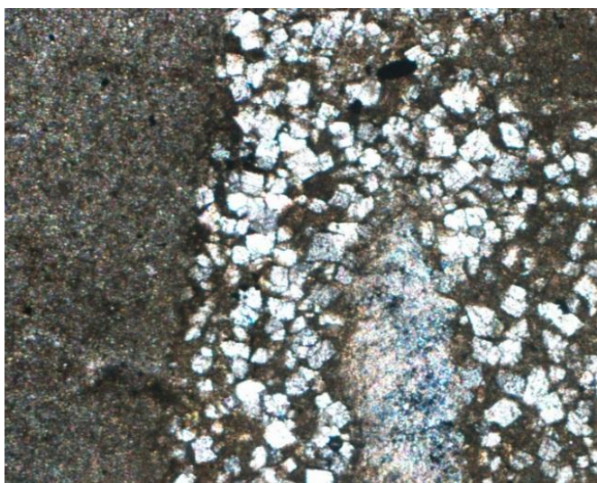
Ph.184 : P1. 1065 m.x4.LP. Epigénie de la micrite par des rhomboédres de la dolomite.
