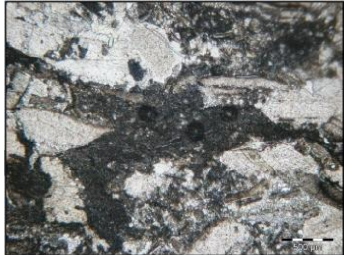
Ph 42a (LP). 42b (LN).x2 . 954.07m : Colmatage des pores de dissolution (Zones sombres)
