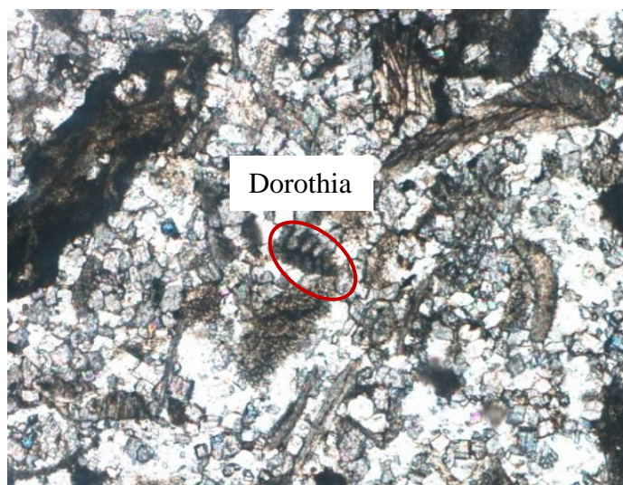
Ph.185 : P2 .936 m.x4.LP. Epigénie de la matrice et des bioclastes.
