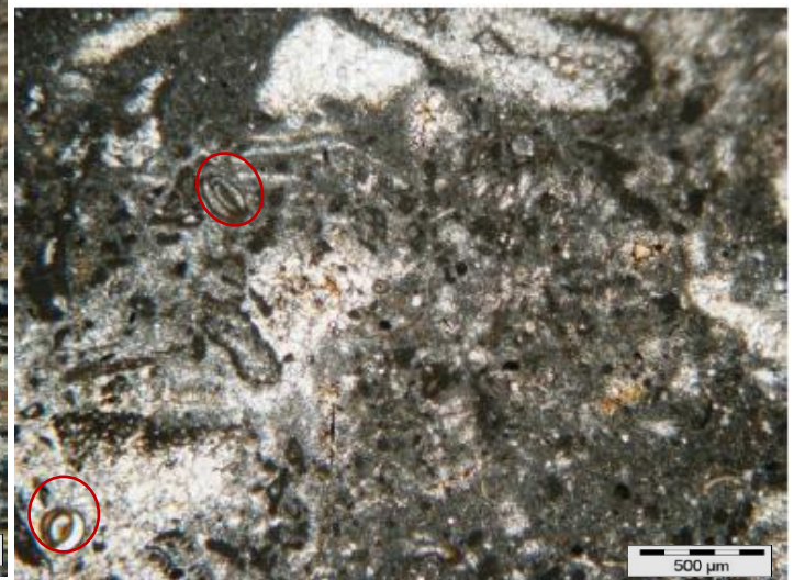
Ph.145 : Wackstone à Miliolidae et débris de Lamellibranches, matrice en voie de recristallisation .x2.LP
