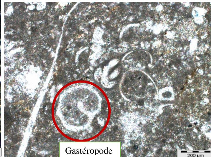
Ph.150 : wackstone à bioclastes recristallisés ; matrice oxydée .x4. LN
