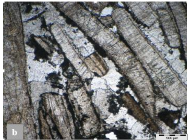
Ph.175 : P2 ; 988.05m .x2. LP Calcite fibreuse
