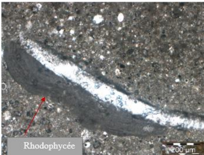
Ph.83 :Wackstone à bioclaste encrouté par des Rhodophycées .x4.LP
