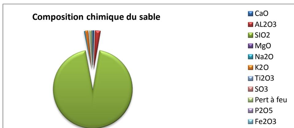
**Figure II.1:** Analyse chimique des sables utilisés.
