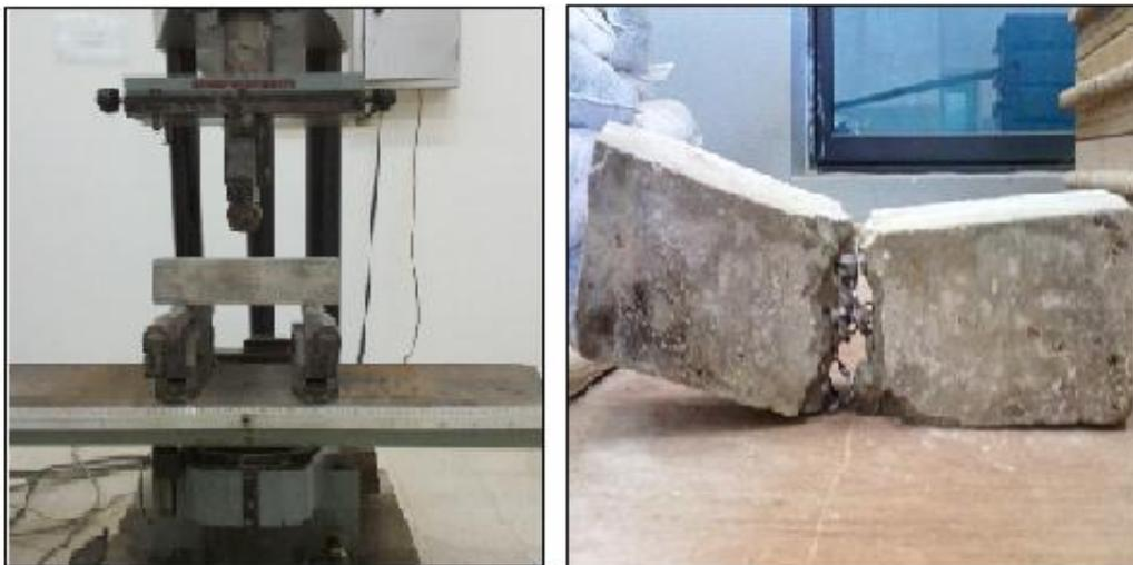
**Figure III.6** : Essai de traction par flexion 3 points.
