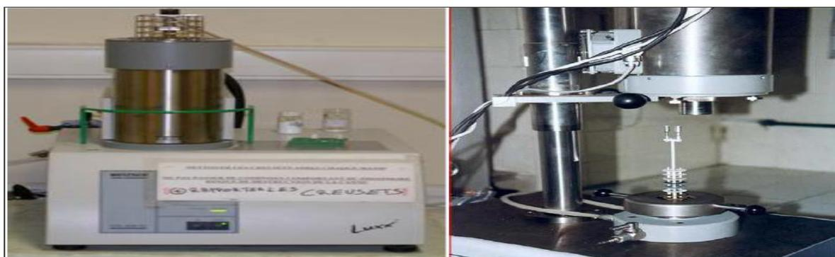
**Figure II.26** : Photographie du dispositif ATD-ATG couplé.
