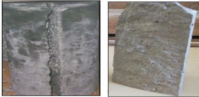
**Figure III.8** : Eprouvette de l'essai de traction par fendage.
