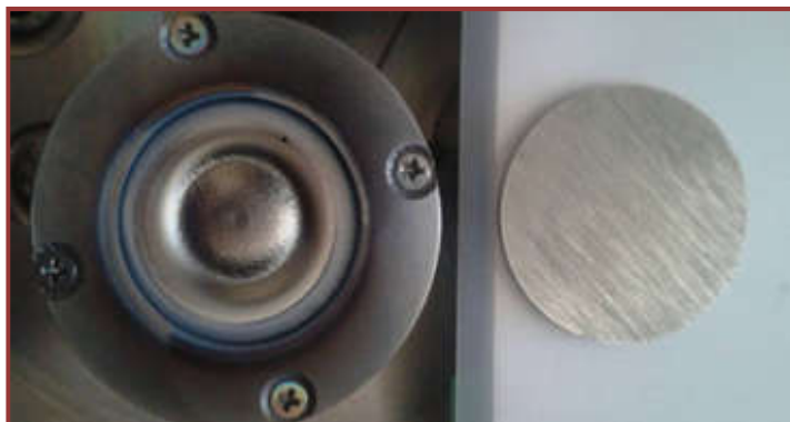
Figure I.12: Photo montrant une cible neuve (à droite) et une cible utilisée en pulvérisation magnétron (à gauche).
