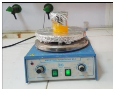
**Figure III.2 :** Agitation du mélange colorant - éthanol afin d'obtenir une solution homogène.
