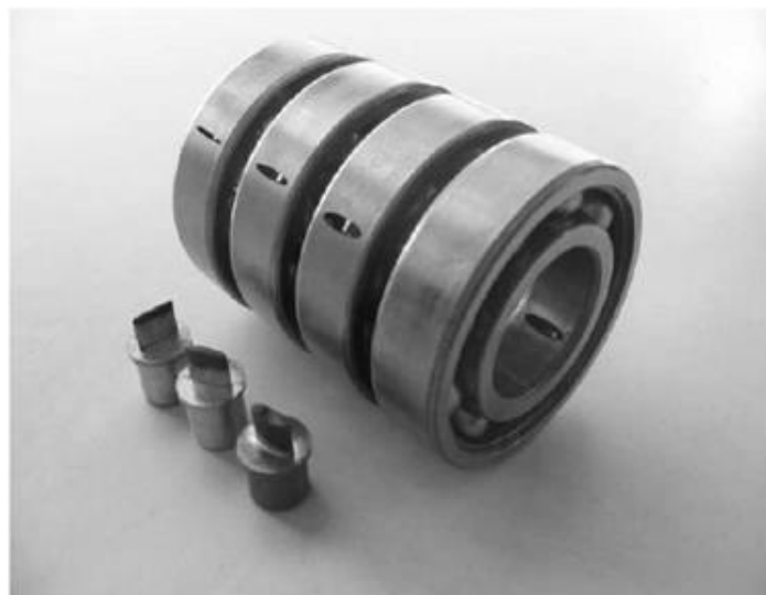
Figure 3.2 : Les Défauts des roulements et leurs dimensions
