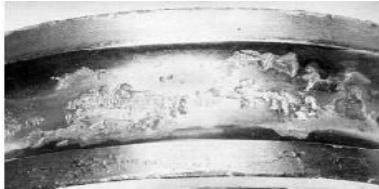
a. dégradation d'un chemin de roulement b. billes éclatées
