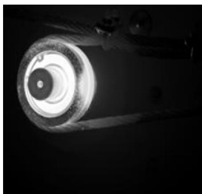
Figure 1.13 : détection du défaut du roulement par la thermographie infrarouge
