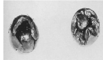
a. dégradation d'un chemin de roulement b. billes éclatées
