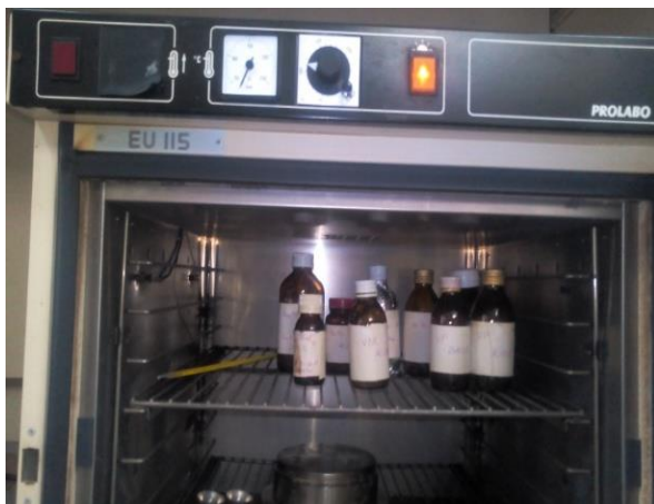
a. Lixiviation statique du verre phosphate en milieu fermé non agité.
