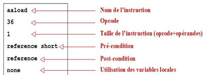
Fig 6.2 – Représentation d'une instruction bytecode dans le fichier d'entrée
