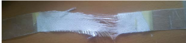
Fig. 8 - Rupture de fibre après essai de traction.
