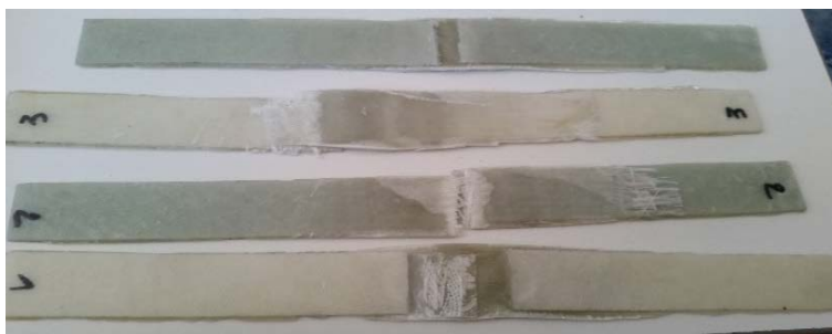
Fig. 30 - Aspect détruite par les essais de traction après réparation
