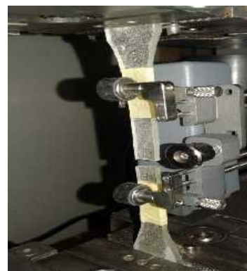
Fig. 5 - Essai de traction sur la machine Zwick
