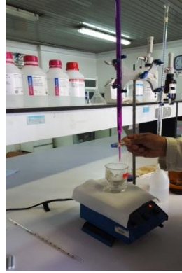
Figure II.9. Protocole de détermination de l'oxydabilité au permanganate de potassium (KMnO 4 )
