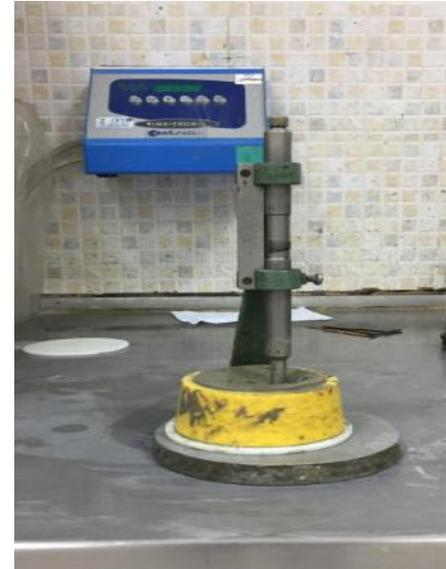
**Figure III.15-** Appareil de Vicat muni de la sonde de consistance
