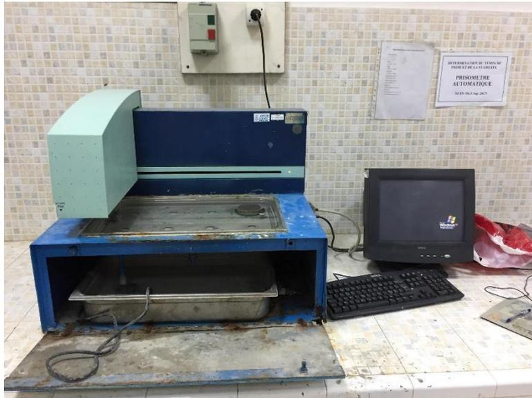
Figure III.16 -Appareil de Vicat automatique
