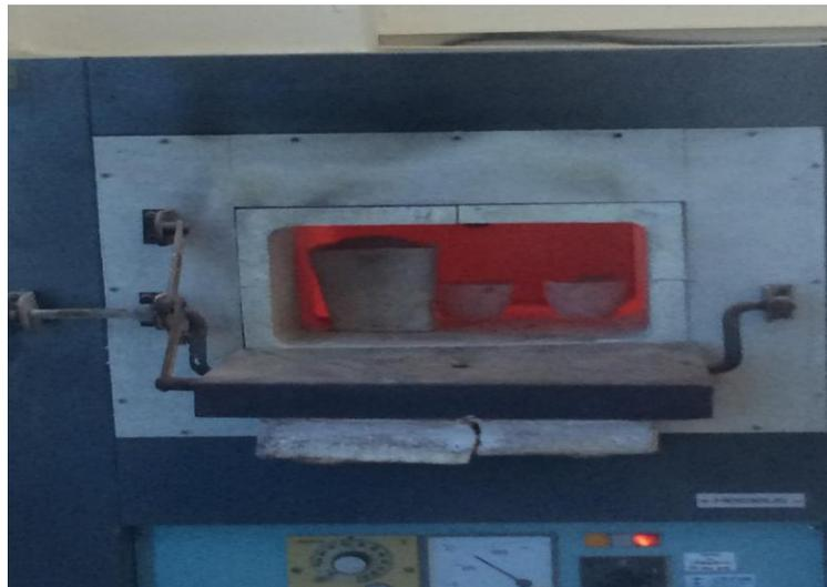
*Figure III.3- Four utilisé durant la calcination de la vase*
