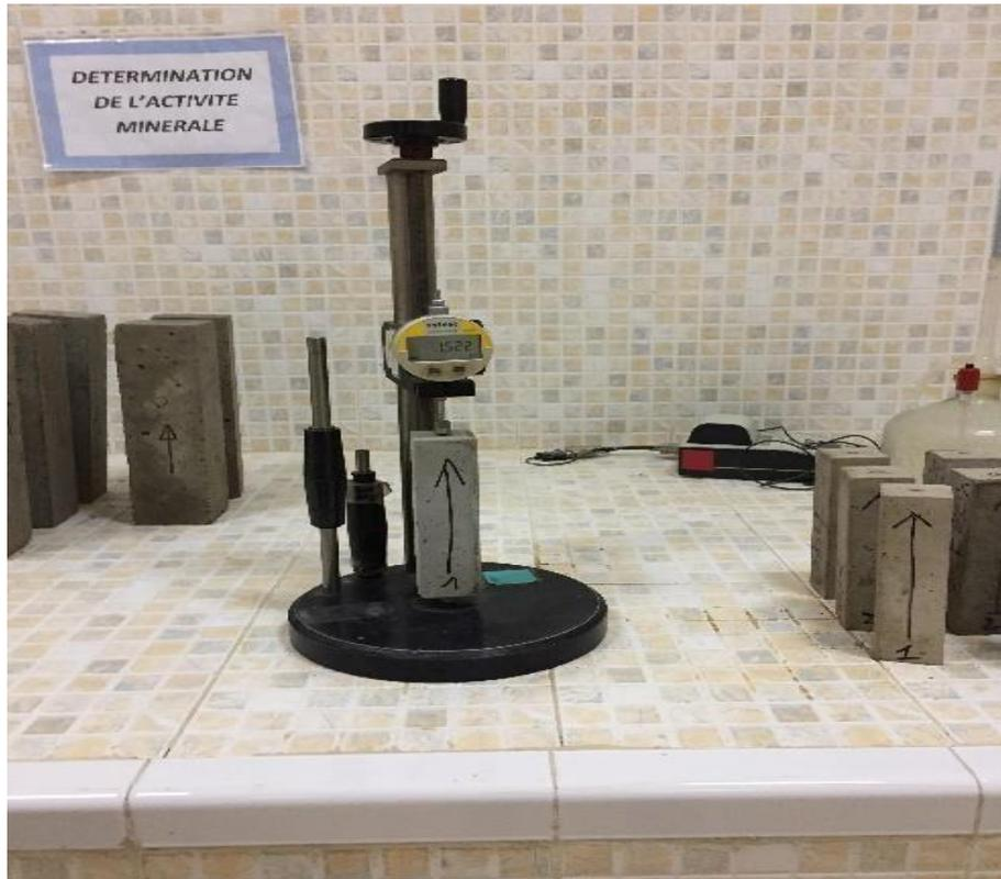
Figure III.24- Appareil de retrait et gonflement.
