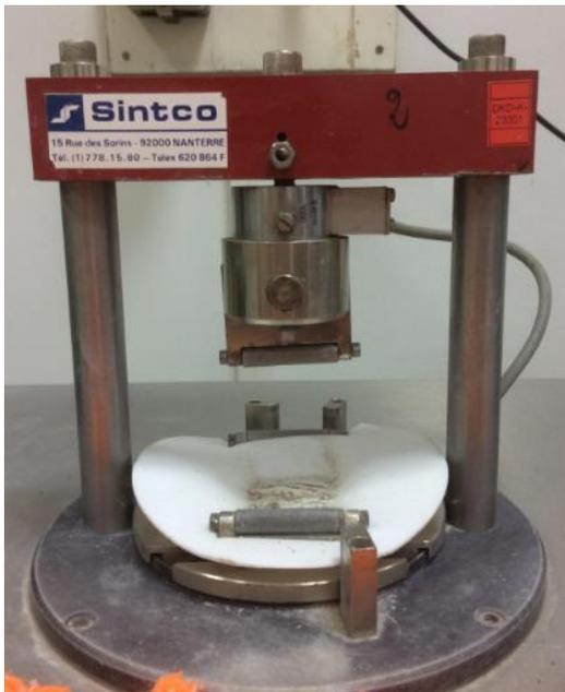
Figure III.22(a) -Appareil de flexion.
