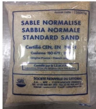
Figure III.11 - Sable normalisé CEN certifié conforme EN 196-1[47].
