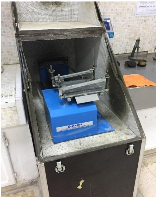
**Figure III.19-** Table à chocs pour Prisme de moule
