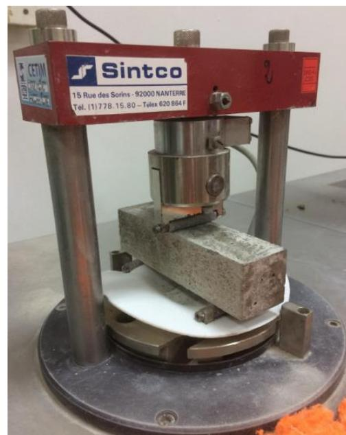
Figure III.22(b) - Essai de flexion.
