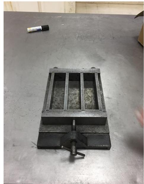
**Figure III.20-** Moule à 3 compartiments pour mortier 4 x 4 x 16 cm
