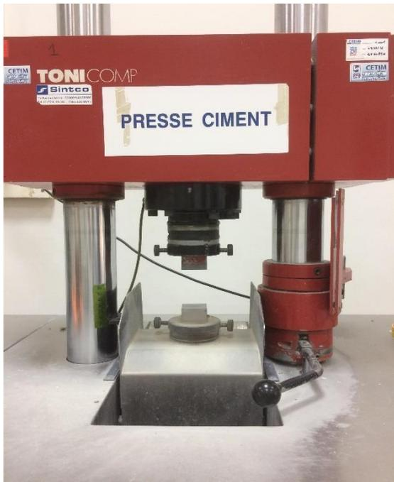
*Figure III.23(a)-Appareil de compression*
