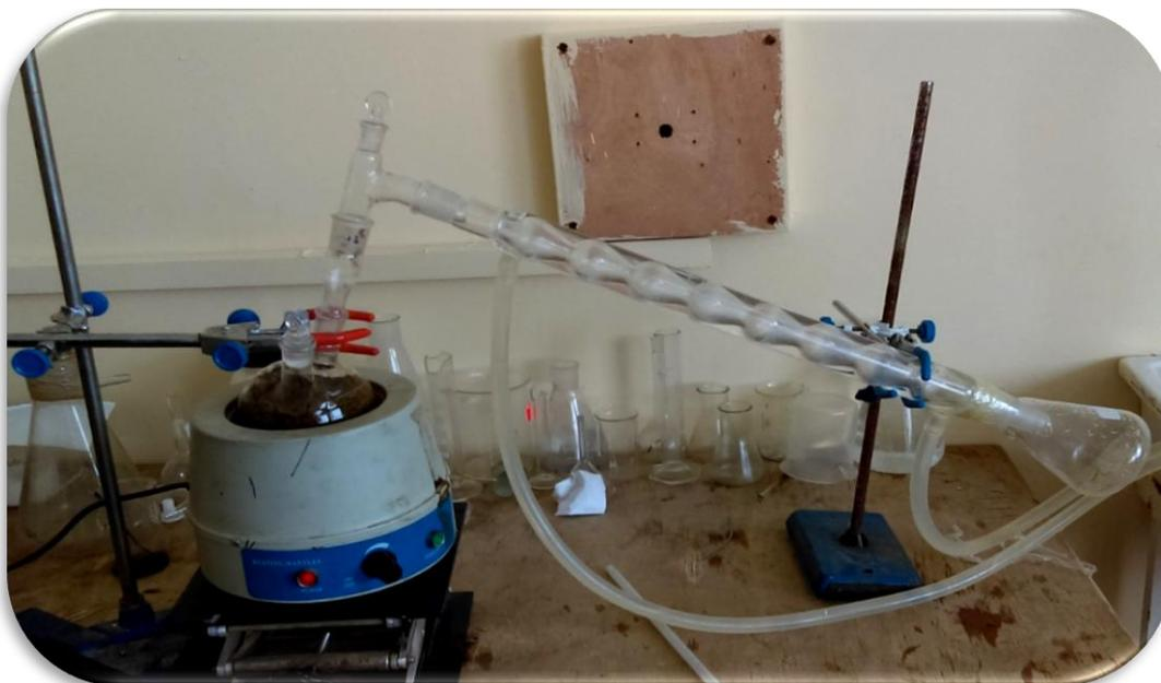
**Figure II.4** : Montage d'hydrodistillation.
