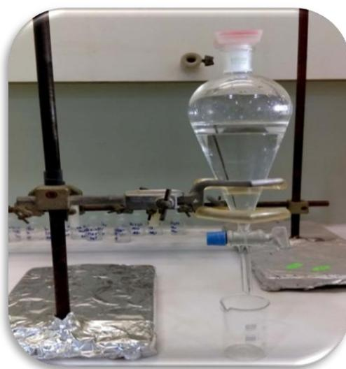
**Figure II.5** : Dispositif de décantation.
