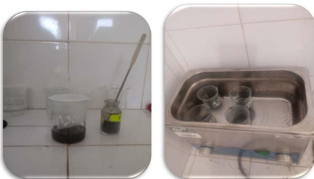
Fig.II.4: Préparation des mélanges matrice /nanoparticules de SiC.
