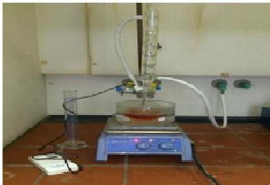
**Figure II.5:** montage de chauffage à reflux
