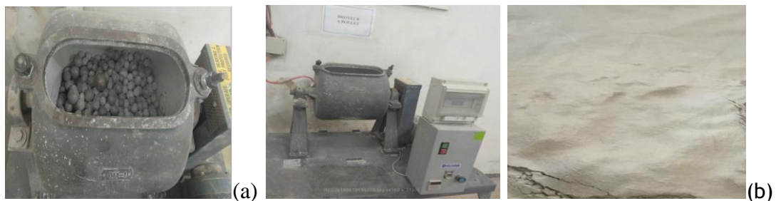
Figure I.3: (a) broyeur à bille, (b) laitier broyé et tamisé.
