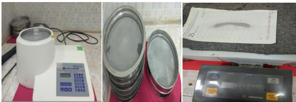
Figure I.8 : l'appareillage de l'analyse Granularité des fillers.
