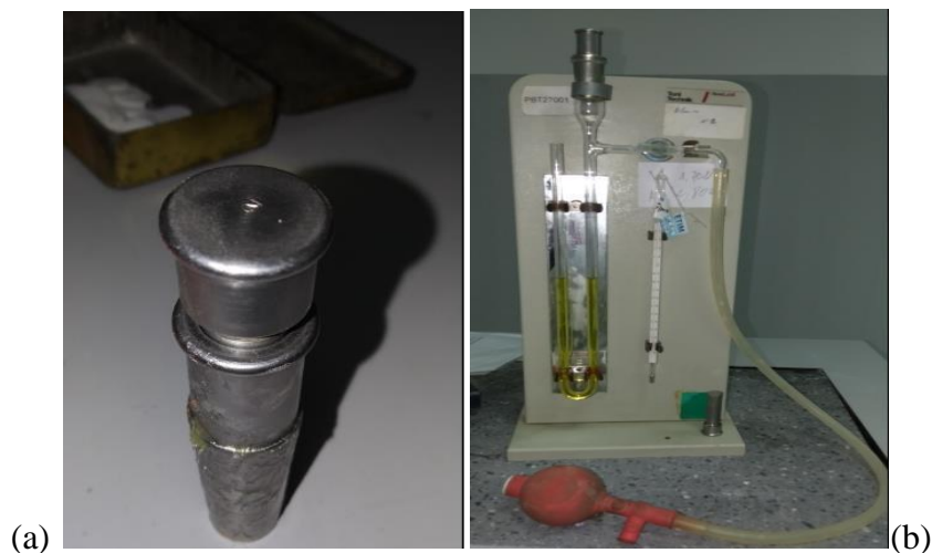
Figure I.7: (a) le piston ; (b) l'Appareil de Blaine.
