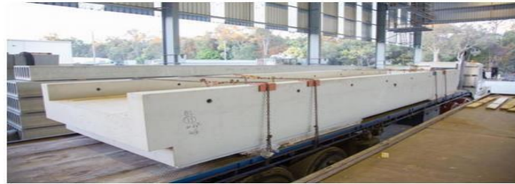
Figure I. 8 : Poutres en béton géopolymère préfabriqué (Architecture & Design, 2013)
