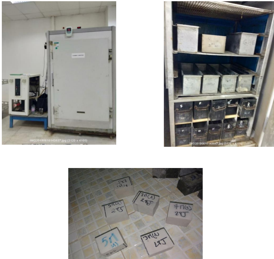
Figure I.13 : Milieux de conservation des éprouvettes.
