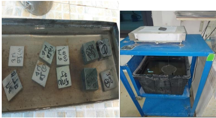
Figure I.14: Balance hydrostatique pour déterminer la porosité accessible à l'eau.
