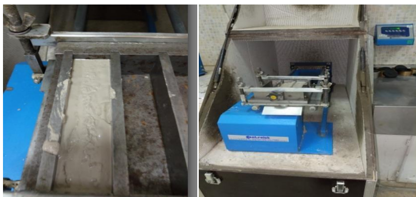
Figure I.11 : Coulage et vibration des éprouvettes.
