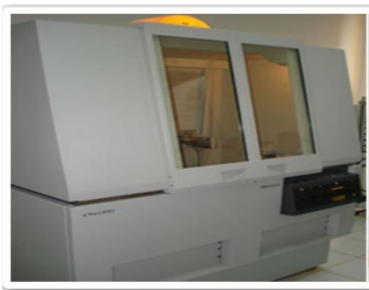
Figure I.16 : l'appareil de Diffraction des rayons X.
