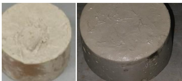
Figure II.9 : Images montrant la lixiviation des MAA conservés sous l'eau pendant 2h.
