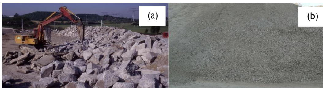
Figure I.1 : Laitier cristallisé : (a) Roches ; (b) concassé
