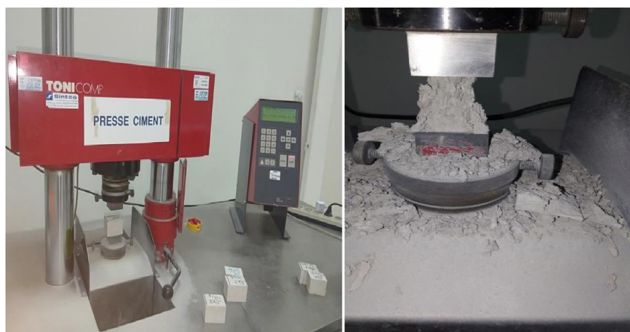
Figure I. 15 : L'essai de compression des éprouvettes.
