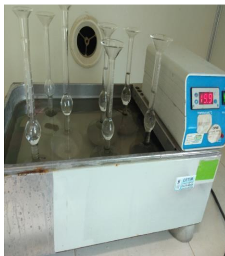
Pycnomètre plonger dans un bain marie de T = 20 \pm 2^{\circ}\text{C}
