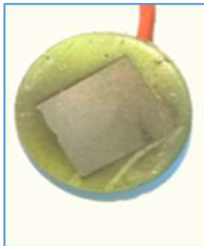
Figure IV.6 : Électrode auxiliaire (le graphite).
