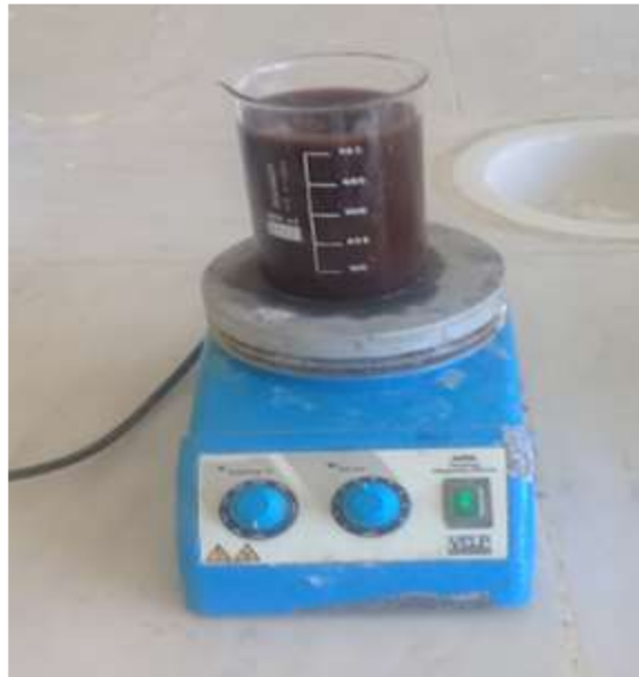
Figure IV.1 : Dispositif expérimental du procédé de Fenton.
