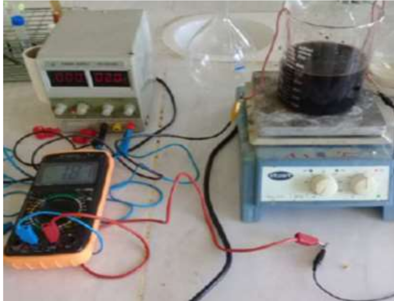
Figure IV.3 : Dispositif expérimental d'électro-Fenton.
