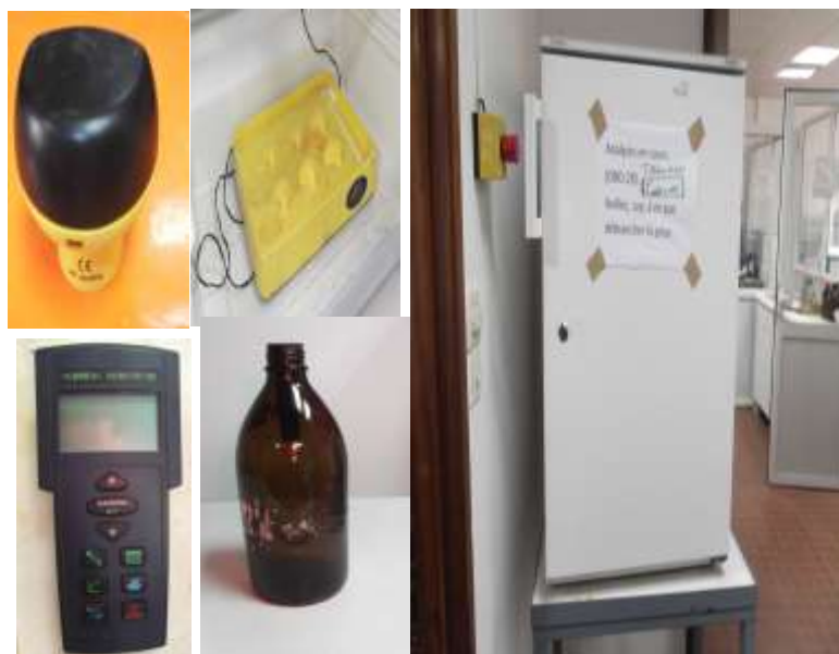
Figure A.6 : Appareil de mesure de la demande biologique en oxygène pendant cinq jours.
