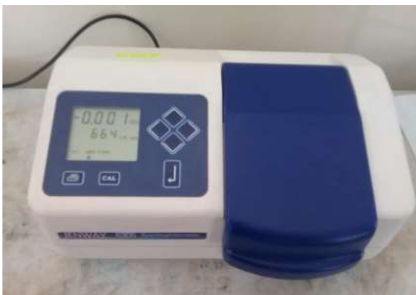
Figure A.1 : Spectrophotomètre UV de marque JENWAY 6305.
