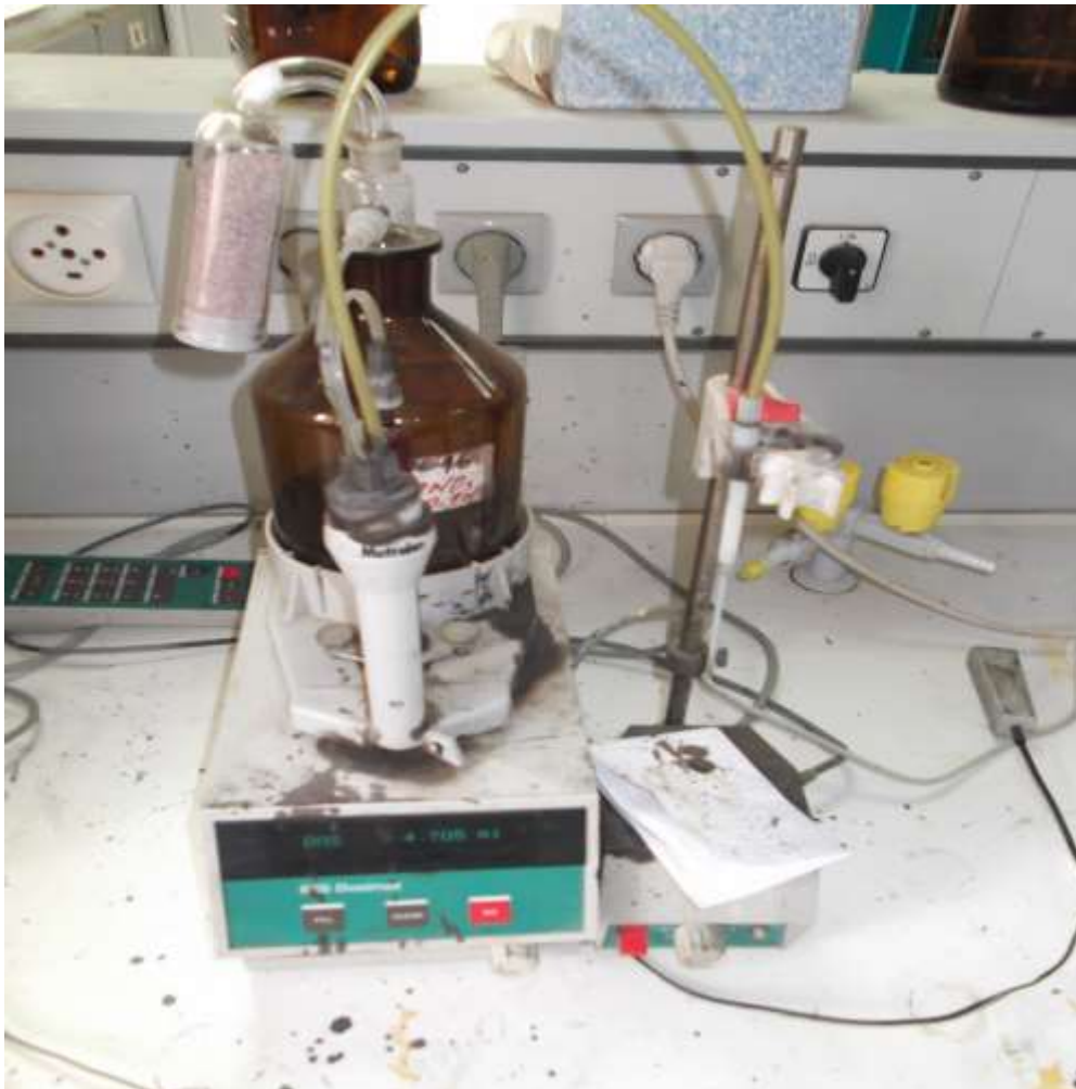
Figure A.4 : Dosimètre des chlorures.
