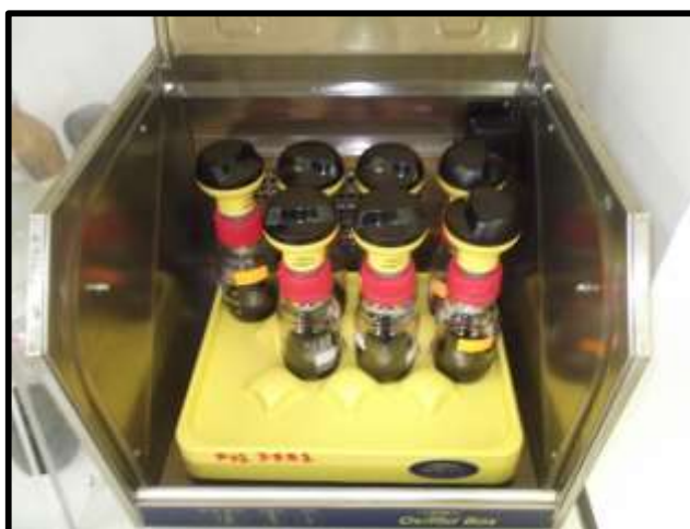
Figure A.5 : Les flacons de la DBO 5 dans l'agitateur pendant cinq jours.
