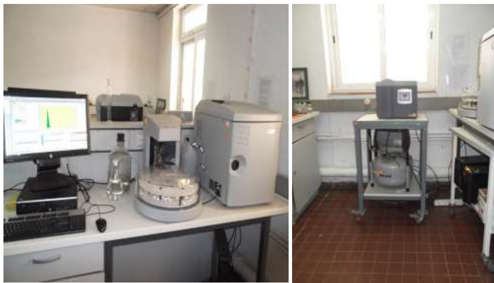
Figure A.9 : Appareil de mesure du carbone organique total.
