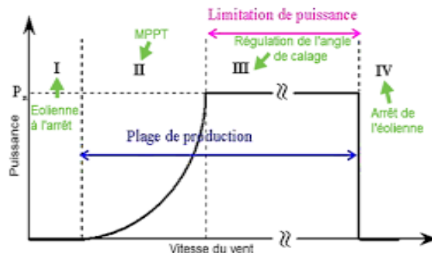
Figure I- 14: Courbe de puissance d'une éolienne (Meziane. 2011)
