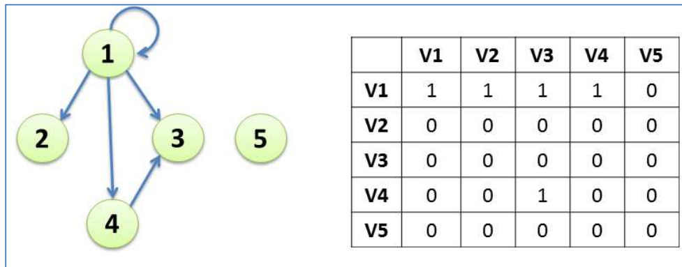
Figure I.11 : Représentation graphique et matricielle d'un graphe orienté.
