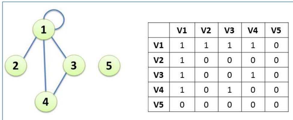
Figure I.10 : Représentation graphique et matricielle d'un graphe non orienté.
