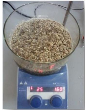
Figure II.6: Activation à l'acide Phosphorique.
