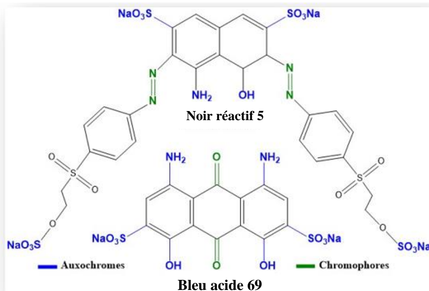
Figure I.1 : Exemple de chromophore et d' auxochrome dans une structure colorante.
