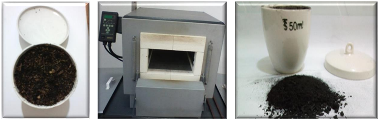
Figure II.7: Les parcelles séchées après activation, four de carbonisation et le charbon actif.
