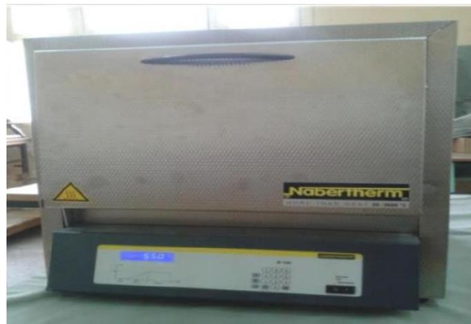
Figure II-3 Four tubulaire de traitement thermique de type Nabertherm. Les éprouvettes à ces trois différents états en été ensuite testés.
