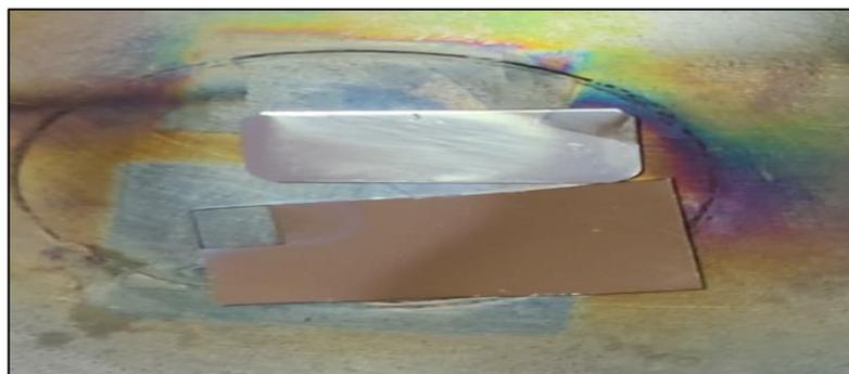
**Figure V.1:** Découpe d'échantillons en verre et en acier
