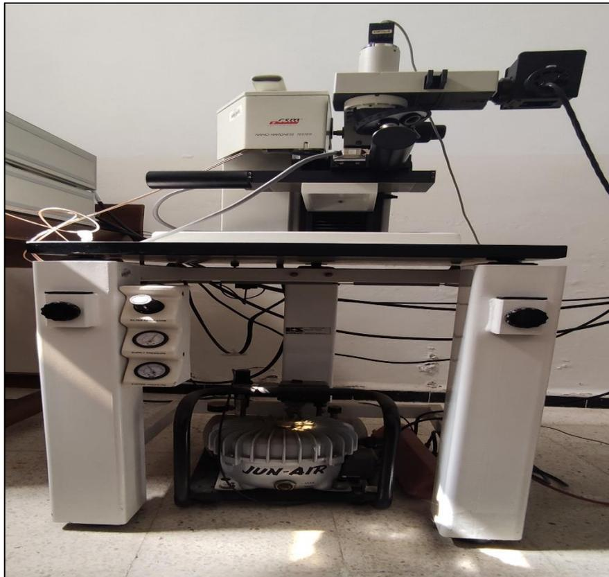
**Figure V.9:** Appareil de nanoindentation CSM-NHT du CDTA
