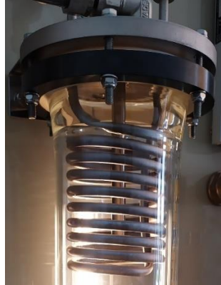
Figure 3.8 – La bobine du condenseur
