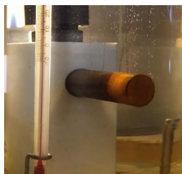
Figure 3.7 – L'élément chauffant de l'appareil
