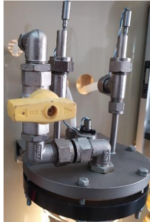
Figure 3.11 – La soupape de dégagement
