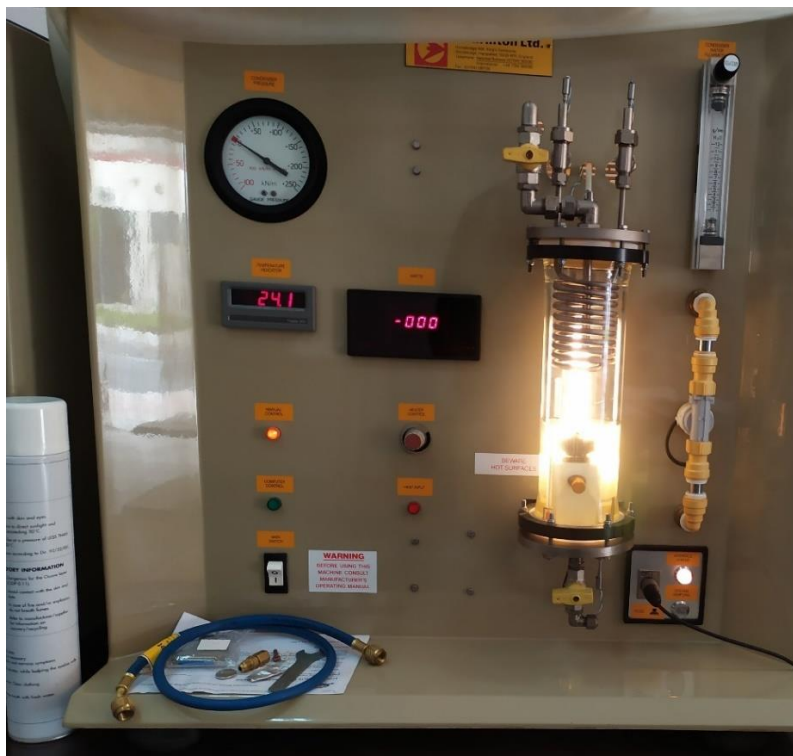
Figure 3.1 – Photo prise de l'appareil de transfert de chaleur par ébullition H655
