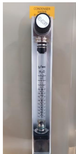
Figure 3.13 – Débitmètre d'eau du condenseur
