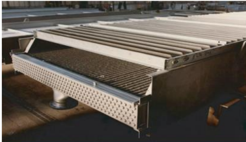
Figure I.9 :Photo des persiennes d'une recirculation interne.
