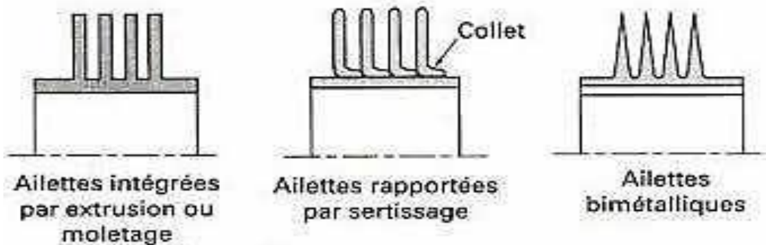
Figure I.6 : Disposition des ailettes circulaires sur les tubes.
