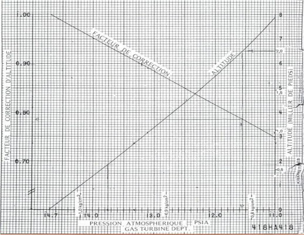
Figure 7.11: courbe de correction d'altitude
