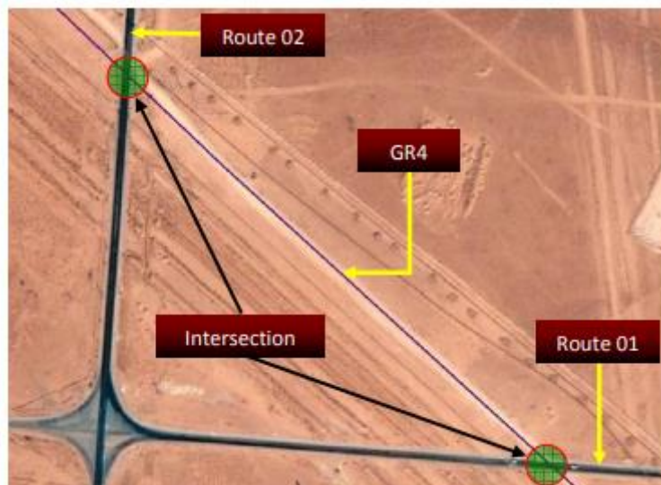
Figure III-5 : Elément sensible 06 et 07 – Intersection avec deux routes Le croisement des routes est pris en compte lors de l'estimation des conséquences d'accidents. Les véhicules qui circulent sur ces routes seront considérés comme des sources potentielles d'inflammation
