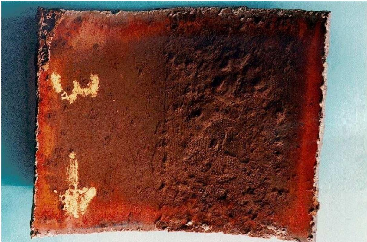
*Figure II.8 : Pertes de métal dues à la corrosion interne.*
