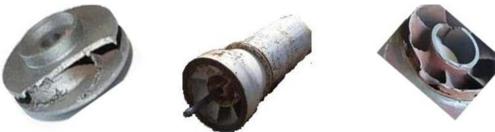
**Figure. II.20 :** Dégâts de Cavitation sur les éléments d'une pompe centrifuge.
