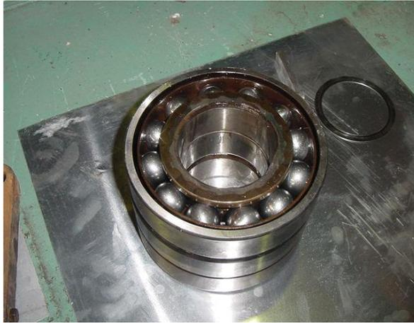
**Figure. II. 10 :** Roulement de palier buté
