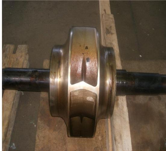
**Figure. II.8 :** Roue de la pompe d'huile chaude
