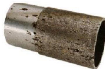
Figure I.6 : corrosion par piqure d'un acier inoxydable
