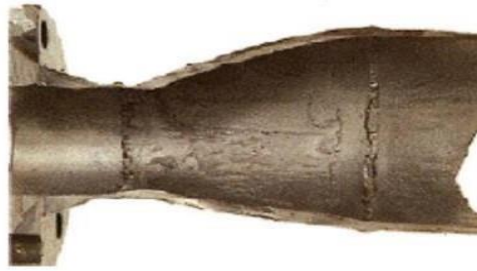
Figure I.9 : corrosion-érosion d'une zone turbulente
