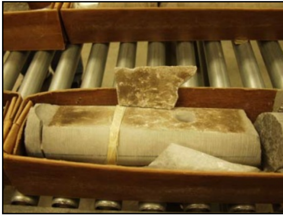
Fractures Naturelles remplies par de l'huile
