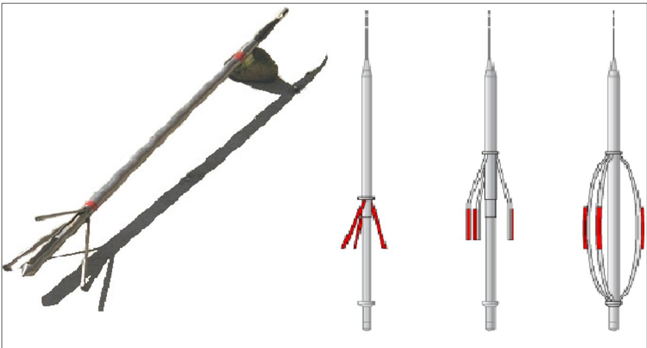
**Figure II.1: Schéma de l'outil de diamétrage (Caliper).**
