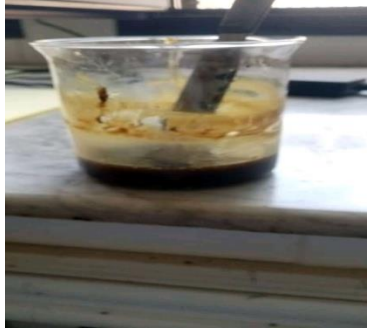
Figure III.8. SBR dissout dans le chloroforme
