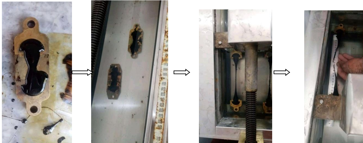
Figure III.15. Schéma illustratif de l'essai du retour élastique
