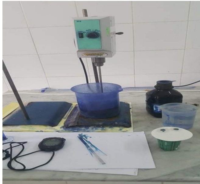
Figure I.9 : L'essai de bleu de méthylène
