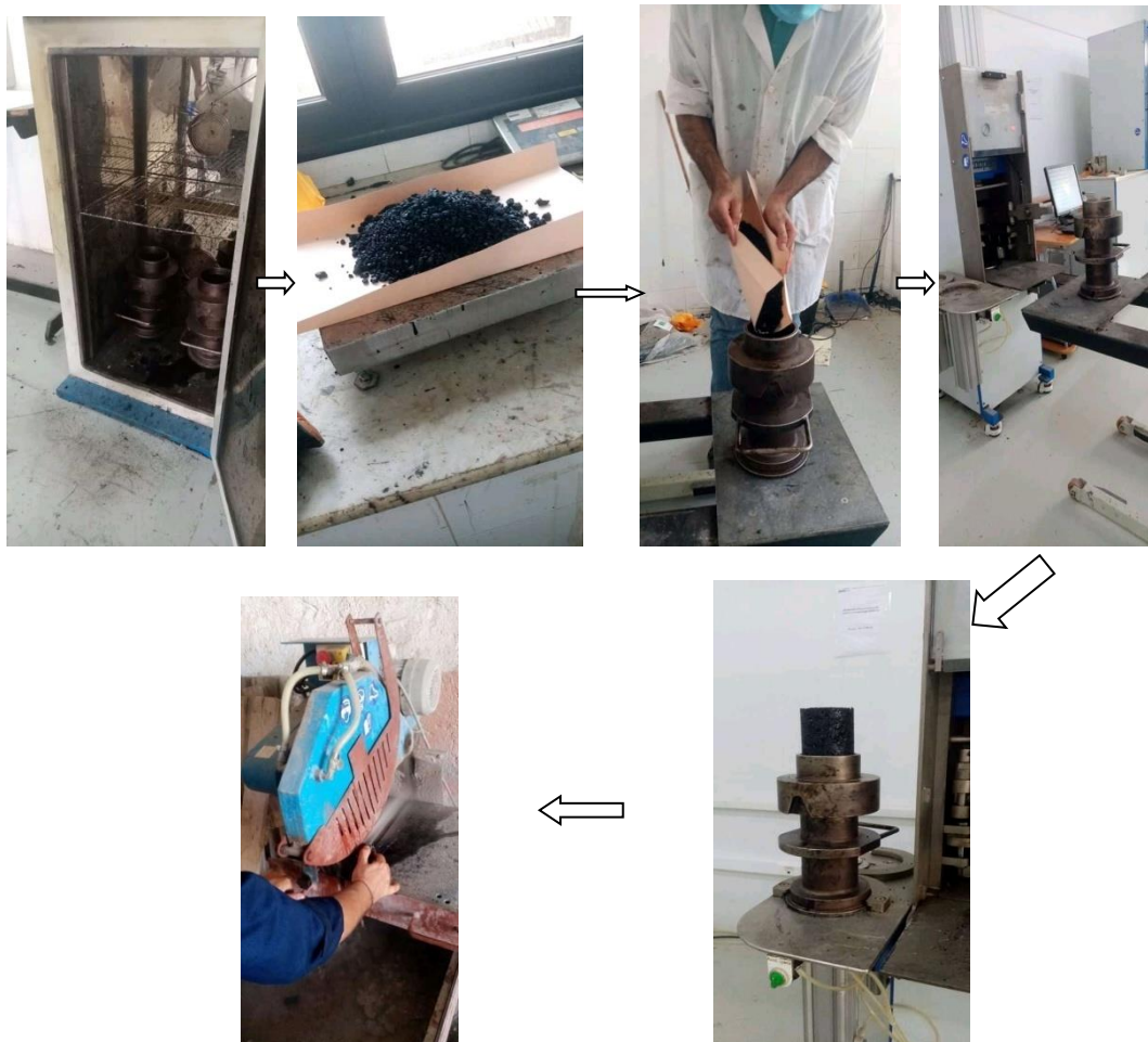
Figure III.20. Schéma illustratif du mode opératoire de l'essai PCG
