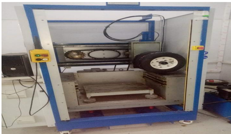
Figure I.14 : Essai de l'orniérage
