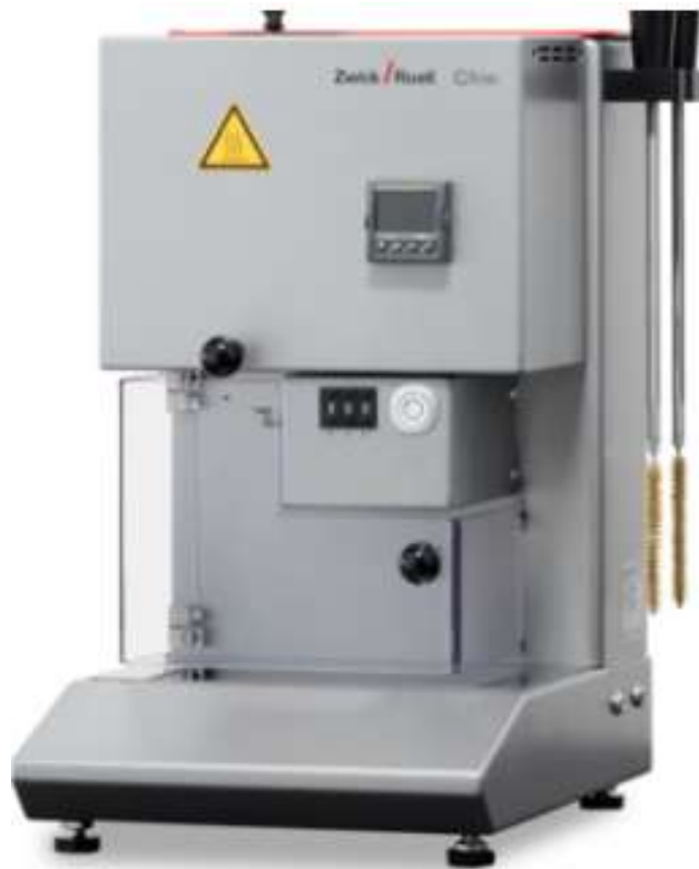
Figure III.9. L'appareil de mesure de l'indice de fluidité du type BMF-001
