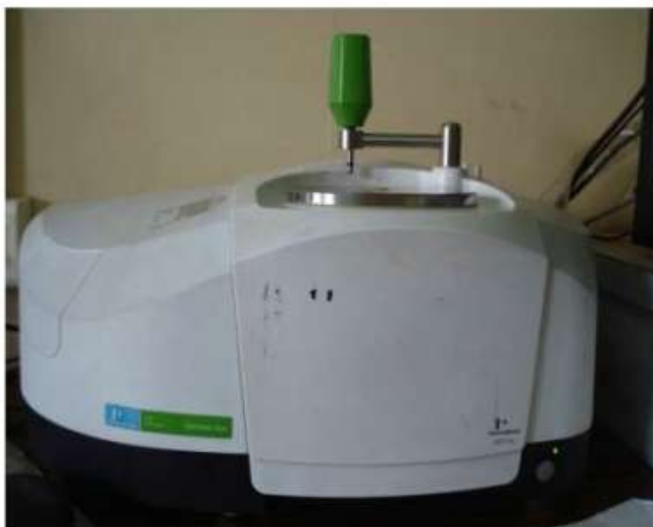
Figure III.7. Appareil de Spectroscopie infrarouge en mode de Réflectance Totale Atténuée (ATR/FTIR).
