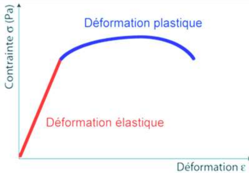
Figure III.12. Diagramme contrainte-déformation en traction d'une éprouvette en plastique [8].
