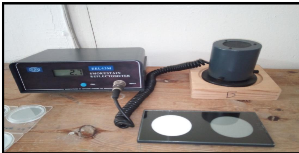
Figure III.6 : Réflectomètre de fumée
