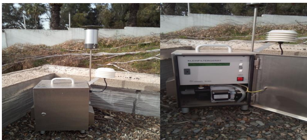
Figure III.2 : L'échantillonneur LVS kleinfiltergerät KFG
