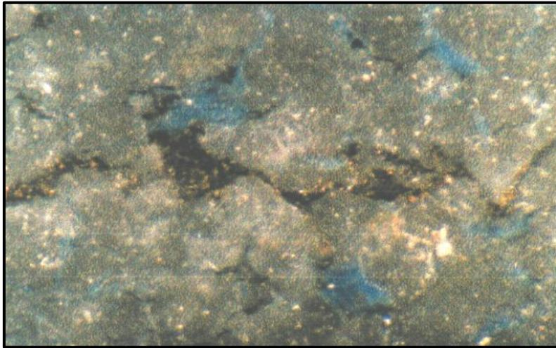
*Figure 29 : AI-2, 2540m LRX100 : Pyrite et matière organique soulignant un microstylolithe*
