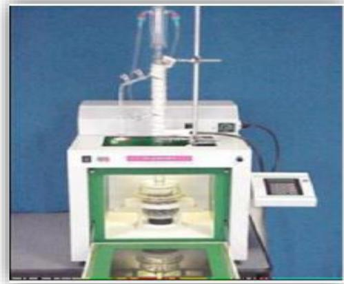
**Figure I.14:** Extraction des HEs par microondes.
