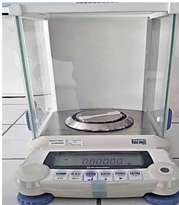
Figure 10 : Balance utilisée pour la mesure du taux d'absorption d'eau.
