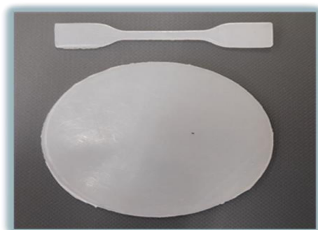
Figure 7 : Eprouvettes en forme de disque et d'haltère pour les différents essais.
