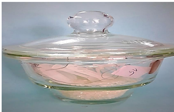
Figure 9 : Les éprouvettes conditionnées dans un dessiccateur.
