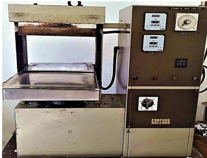
Figure 6 : Vue de la presse utilisée pour la fabrication des plaques de PE.
