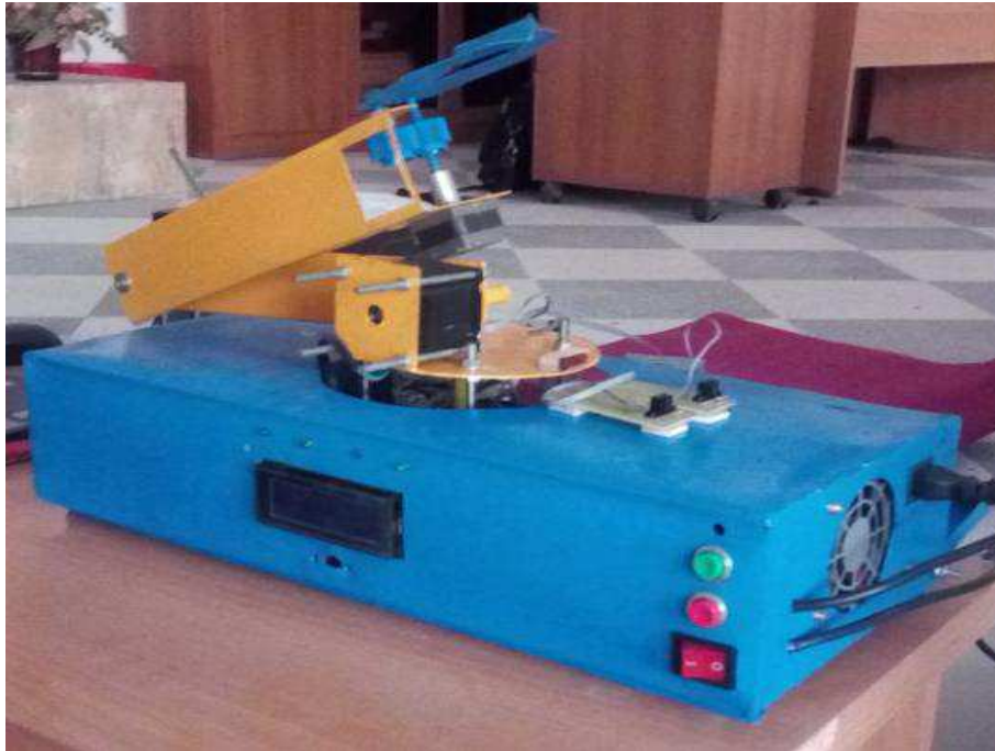
Figure 5.21: Le bras manipulateur dans l'état final
