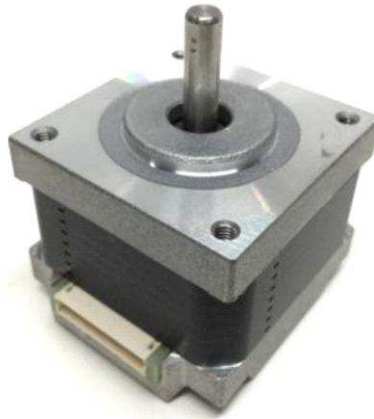
Figure 2.14: Aperçu du moteur pas à pas nema17
