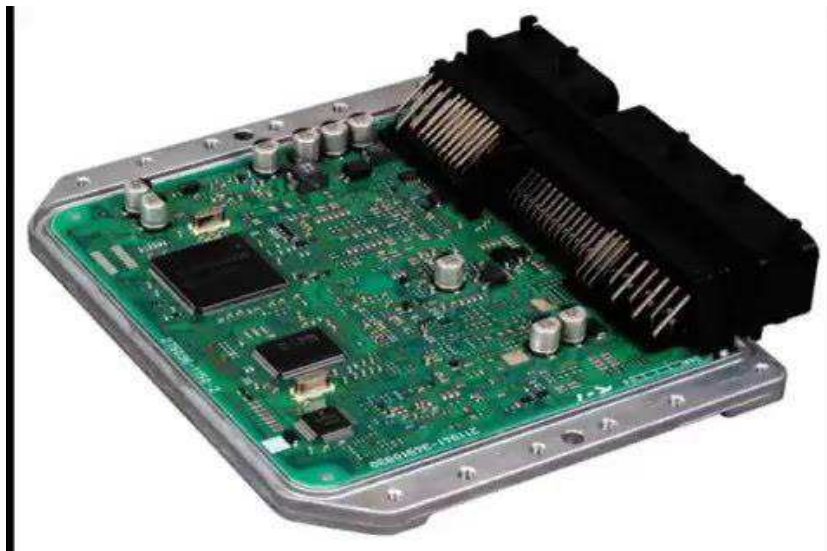
Figure 3.1: Aperçu d'un calculateur moteur (système embarqué)
