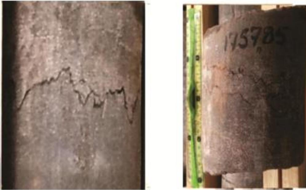
**Fig. II.8:** Photos de carottes (Unité III-2, P2) montrant les stylolites horizontaux.
