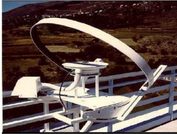
Figure I.14. Pyranomètre avec anneau d'ombrage.
