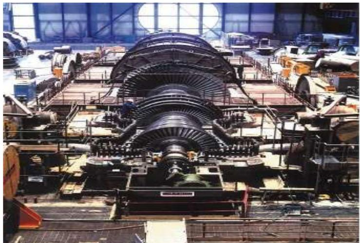
**Figure (I.2) : Turbine à vapeur sans tablier.**
