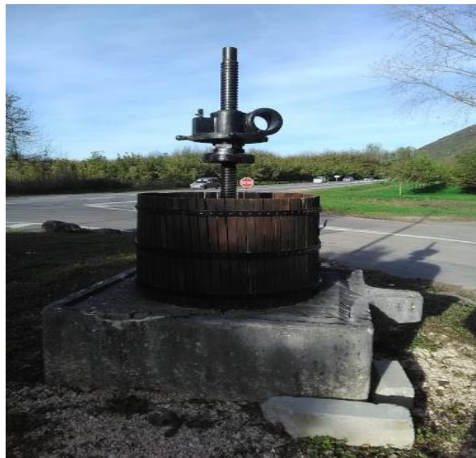
Figure I.8 : Pressoir à raisin, dans ce cas, l'expulsion du fluide se fait radialement.
