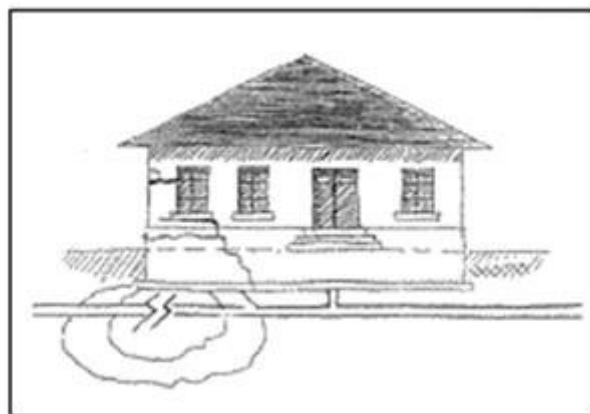
Figure I.3: rupture de canalisations suite à un tassement uniforme.
