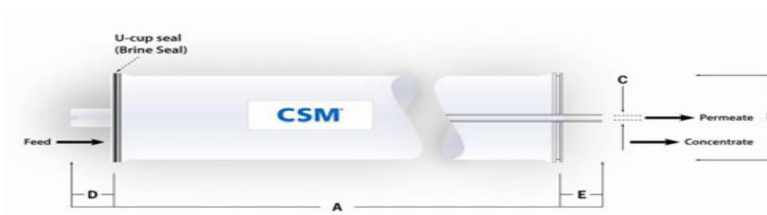
Figure 66. Démontions de membrane
