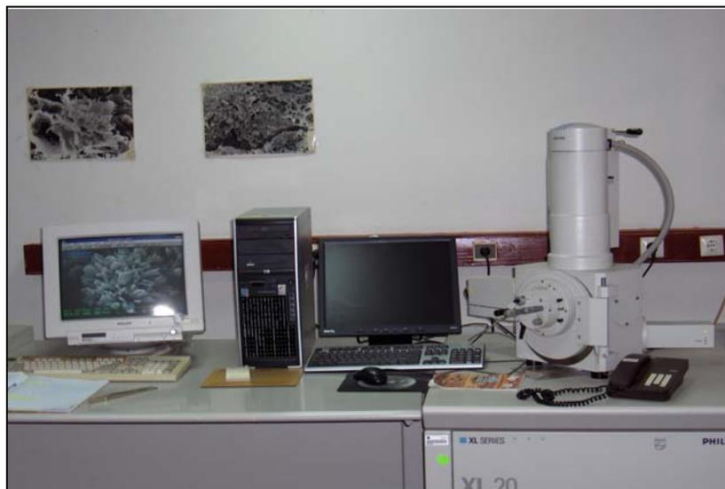
**Figure 17 : Microscope à balayage électronique**
