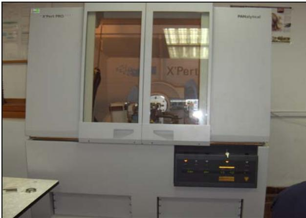
**Figure 18 : Diffractomètre rayons X**
