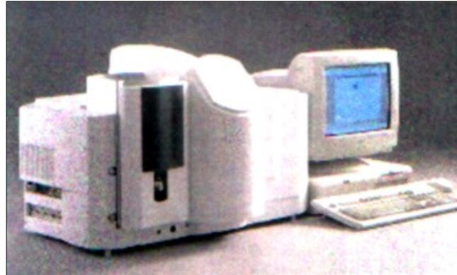
**Figure 22 : Spectromètre d'absorption atomique.**
