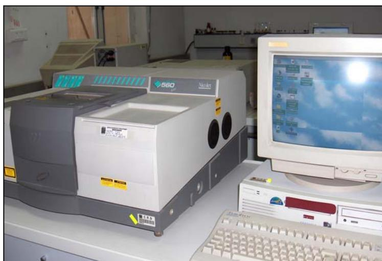
**Figure 19: Spectrophotomètre infrarouge**
