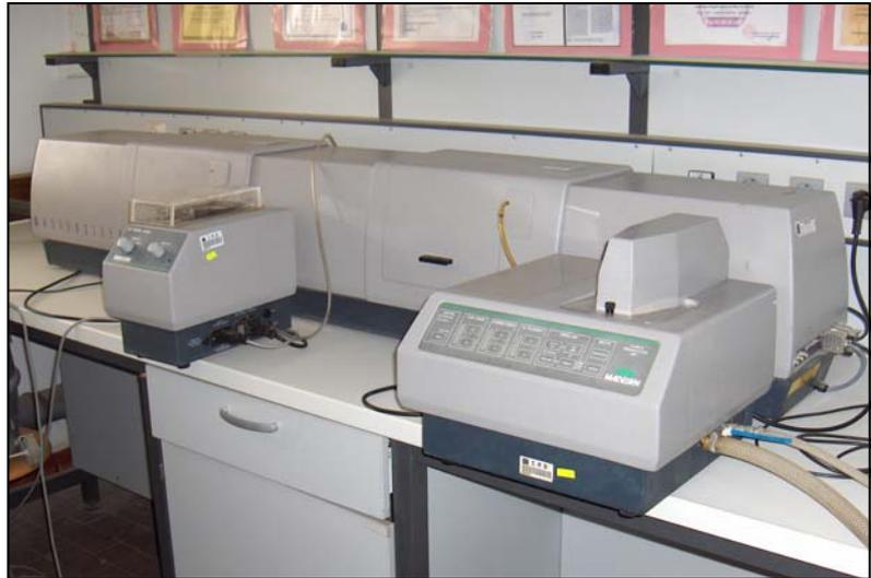
**Figure16 : Granulomètre laser**
