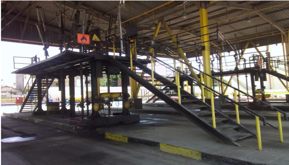
**Figure 22 : Passerelle et Eclairage de poste de chargement**
