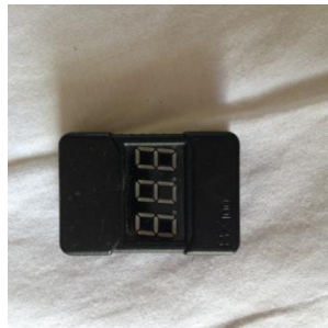
Figure 4.69 : Moniteur de voltage
