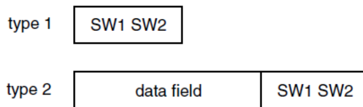
Figure 3.44 : Les deux types d'APDU de réponse
