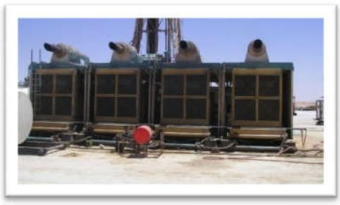
Fig1.5 .Moteurs Diesel
