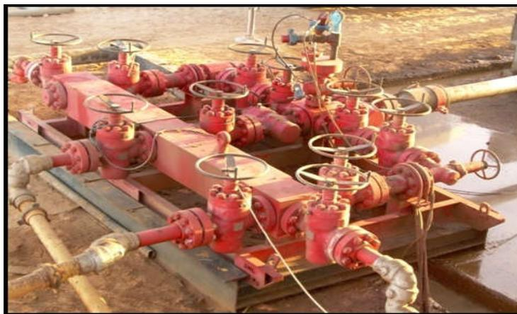
Fig 1.11 Manifold de duses
