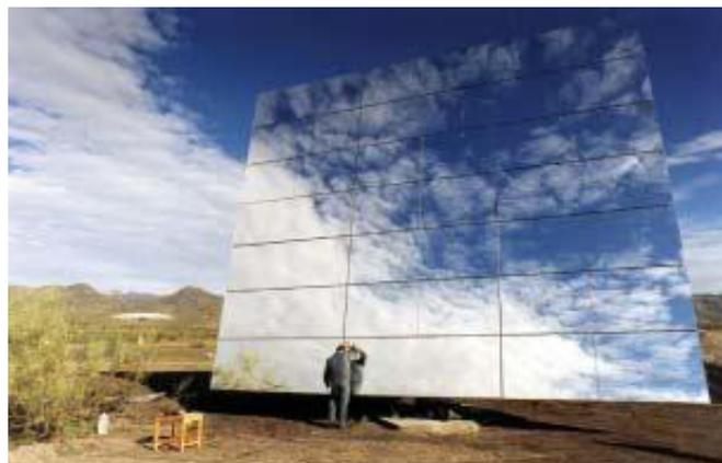
**Figure III.5** : héliostat.
