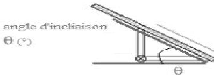
Figure I.14 : Représentation de l'angle d'inclinaison  $\theta$ .
