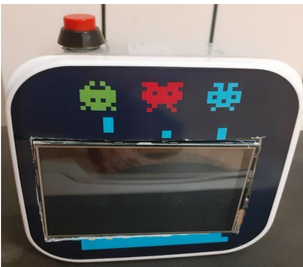
Figure 3.9 : Insertion des composants du projet dans un boîtier de protection.
