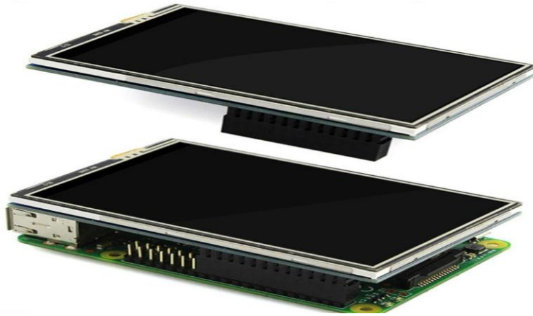
Figure 3.7 : branchement de l'écran LCD sur Raspberry
