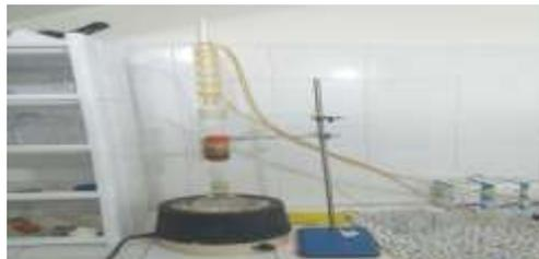
Figure n°18: Extracteur Soxhlet
