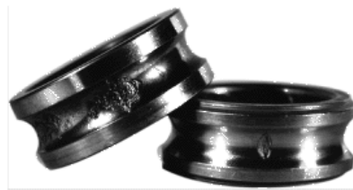
(a) défaut : écaillage de la bague interne
