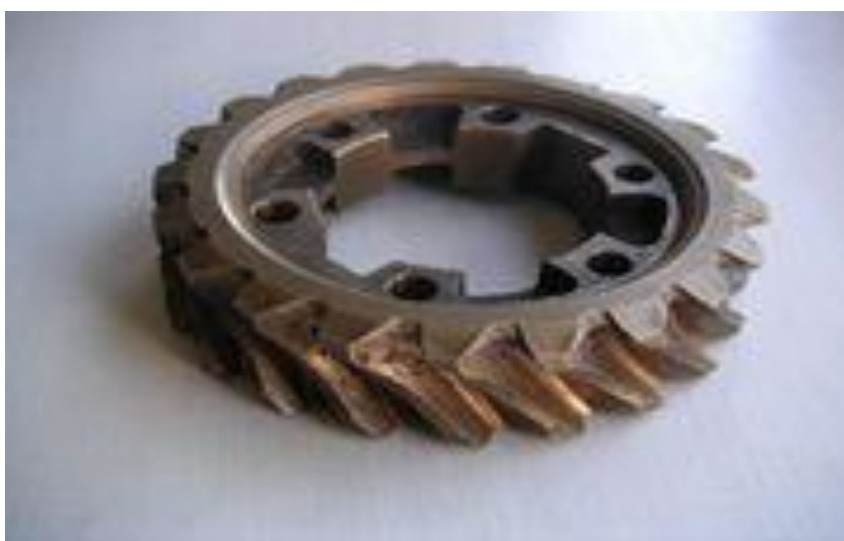
Figure 1.11 : Dégradation des dents d'une roue dentée
