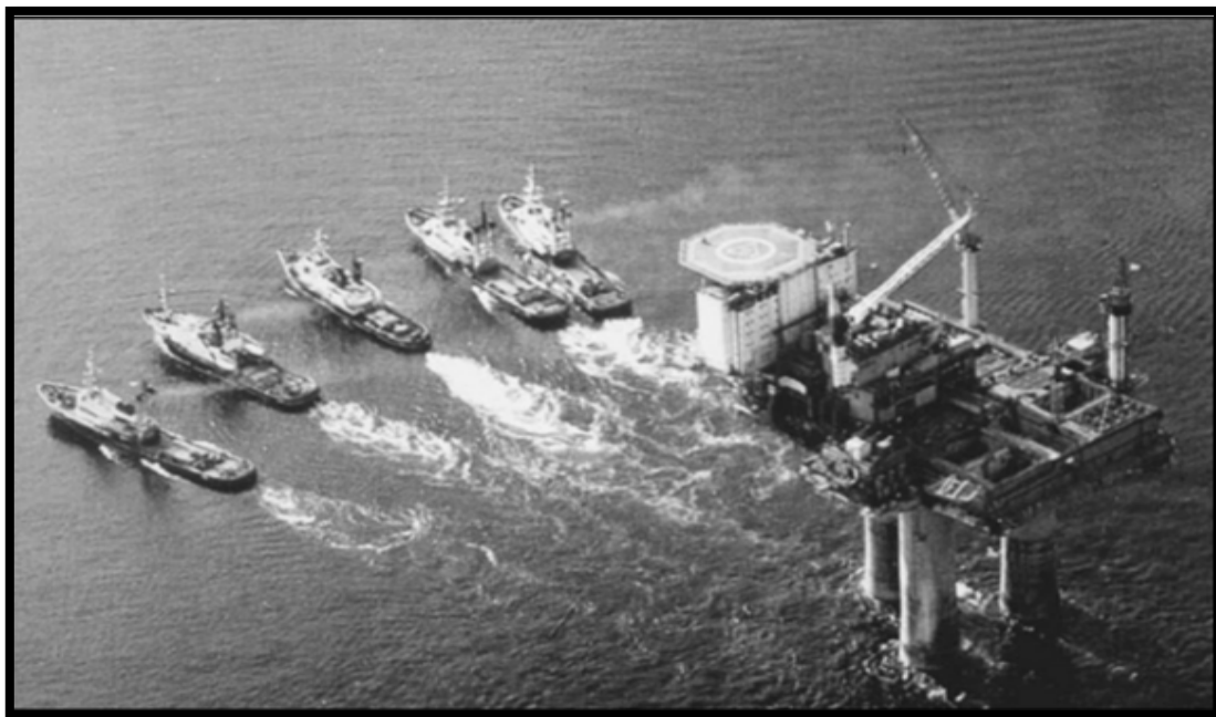
Figure 3: Remorquage d'une plateforme gravitaire d'exploitation d'hydrocarbures en mer du Nord (BONTON et al. , 2015).
